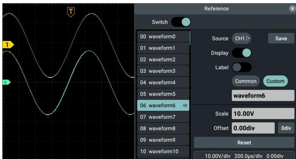
CH1チャンネルの波形を波形0に保存するには、以下の手順に従ってください:
