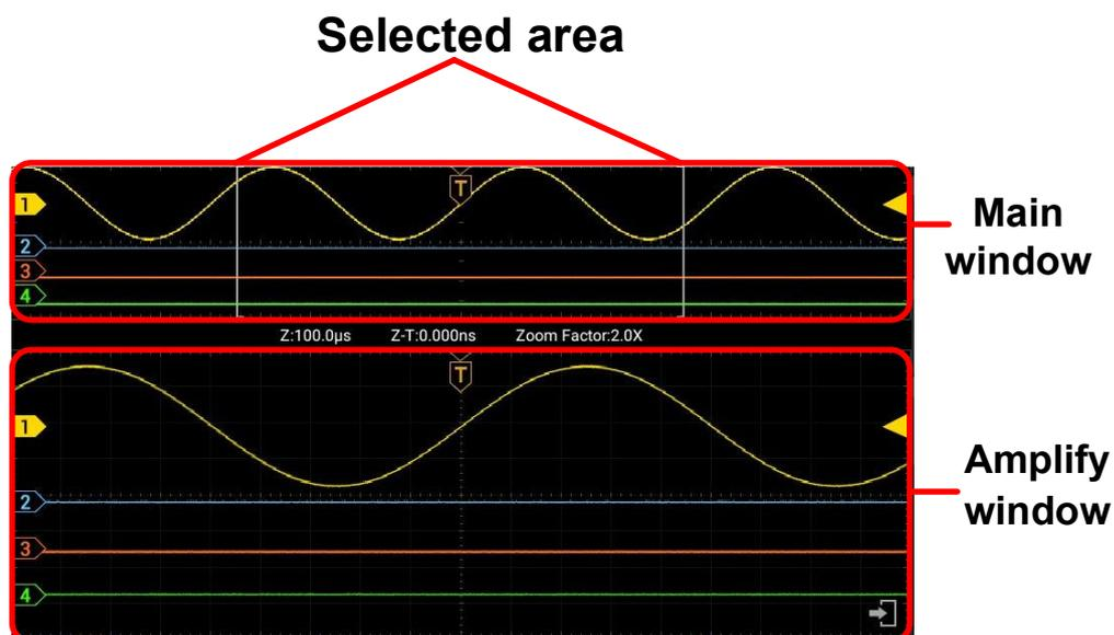
通常モードでは、**水平位置**ノブと**水平 スケール** ノブを使用して、メインウィンドウの水平位置と水平時間基準を調整します。
